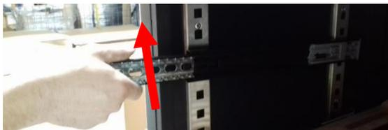
**5** - Ziehen Sie den Schlitten nach oben aus dem Gerät heraus
